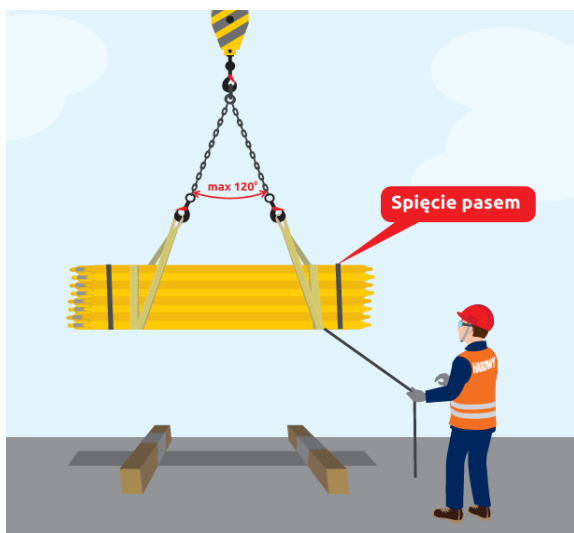
Rysunek 5 Spięcie dźwigarów pasem obwodowym i zawieszami pasowymi
