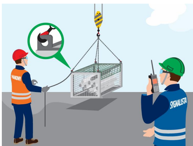
Rysunek 3 Zastosowanie kosza szalunkowego
